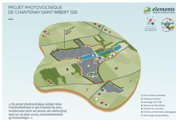
ELEMENTS doit aujourd'hui réaliser les études et engager les procédures nécessaires. Sur terrains dégradés, cette centrale de 17 ha permettra une production électrique estimée entre 13,77 et 15,41 MWh. Elle assurera des revenus supplémentaires au SYCTOM et à la collectivité (indemnités d'immobilisation / loyers annuels / retombées fiscales).
